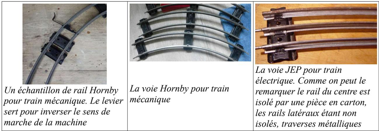
Remarques : les rails proprement dits sont obtenus en tôle roulée et pliées, il n'y a pas de ballast, les éclisses sont obtenues avec une vulgaire pointe que l'on enfonce dans le profilé du rail suivant. Nous sommes donc en faux trois rails : les rails externes ne sont pas isolés.
